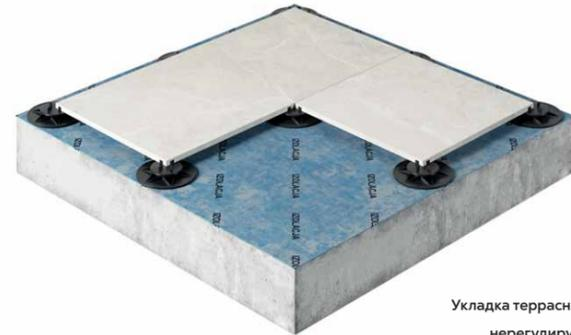
Укладка террасной плитки на нерегулируемые опоры
